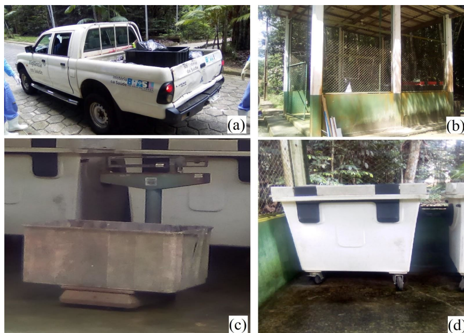
FIGURA 6 – Coleta, pesagem e armazenamento dos resíduos: (a) Veículo responsável pela coleta; (b) Galpão para o armazenamento temporário dos resíduos; (c) Balança utilizada na pesagem dos resíduos; (d) Contentores e armazenamento temporário. Fonte: Autores, 2018
