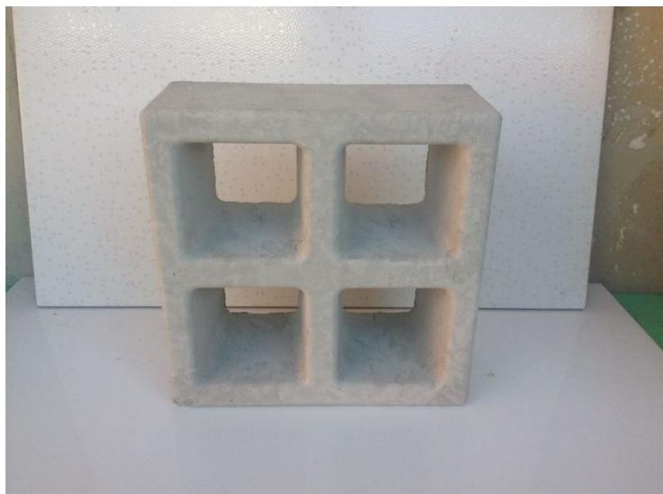
**Figura 3: Cobogó fabricado com rejeito de granito. Fonte: Autor do Trabalho.**
