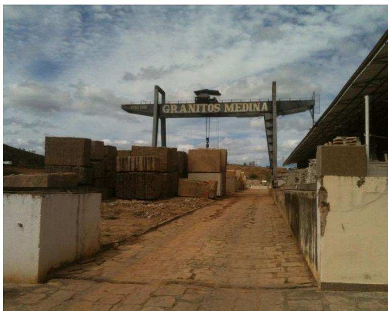
Figura 1: Ponte que descarrega os blocos de granito e pátio onde são armazenados. Fonte: Autor do Trabalho
