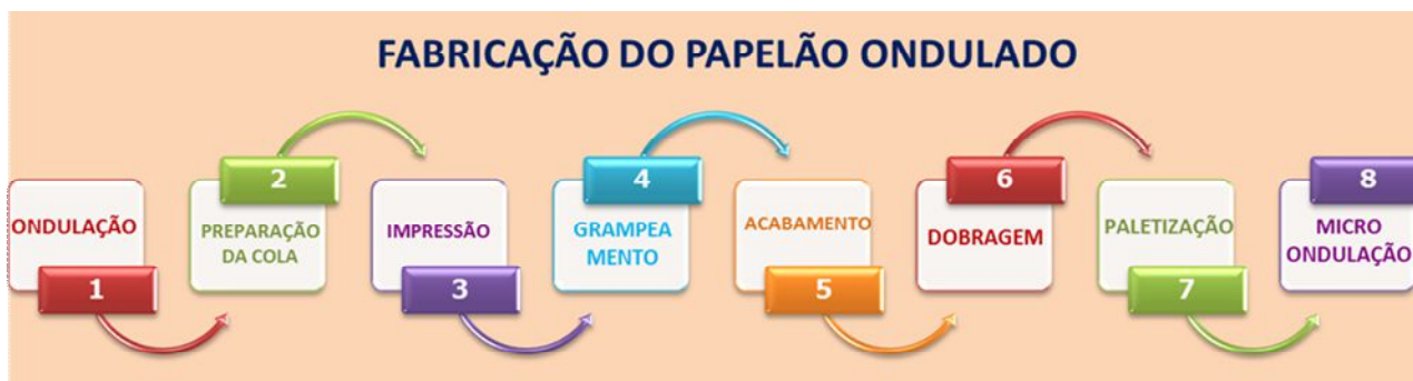
Figura 3 - Etapas do processo de fabricação do papelão ondulado. Fonte: Autora.
