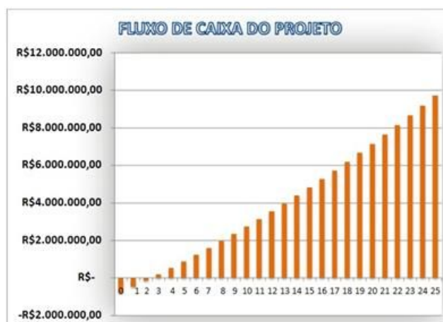
Figura 1- Fluxo de caixa relativa ao período de 25 meses a partir da suposta instalação de conjunto gerador de energia elétrica com placas fotovoltaicas.
