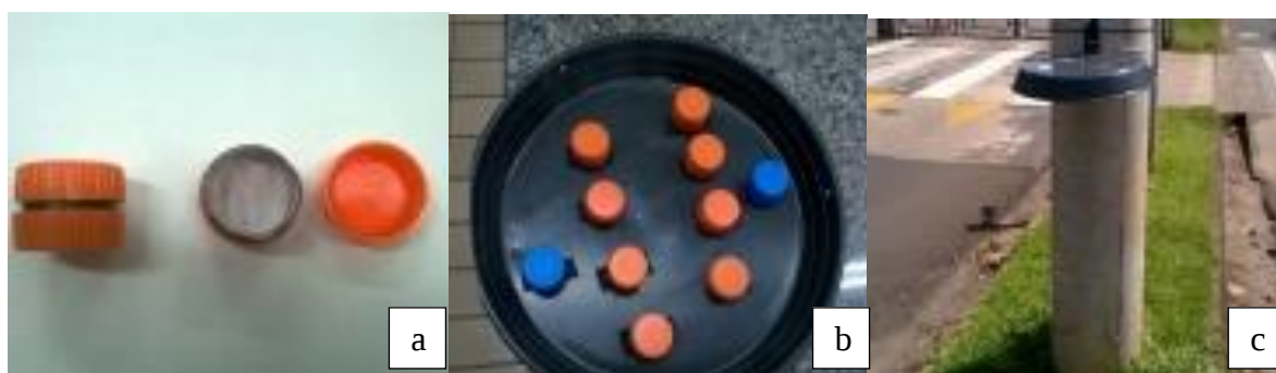
Figura 1: Amostrador passivo confeccionado para a pesquisa (a), distribuição dos amostradores no suporte de fixação (b) e posicionamento do conjunto no local de amostragem (c). Fonte: Autora do Trabalho.
