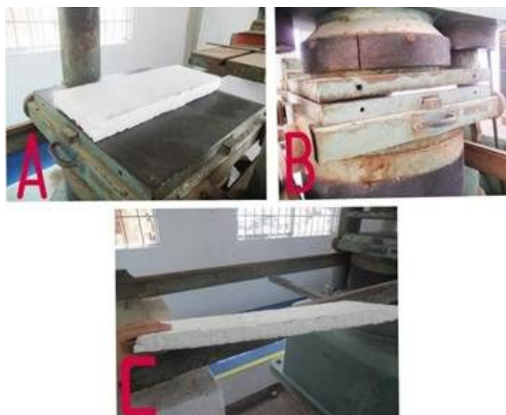
Figura 3: Processo de realização do teste de resistência à compressão. Fonte: Autor do trabalho.
