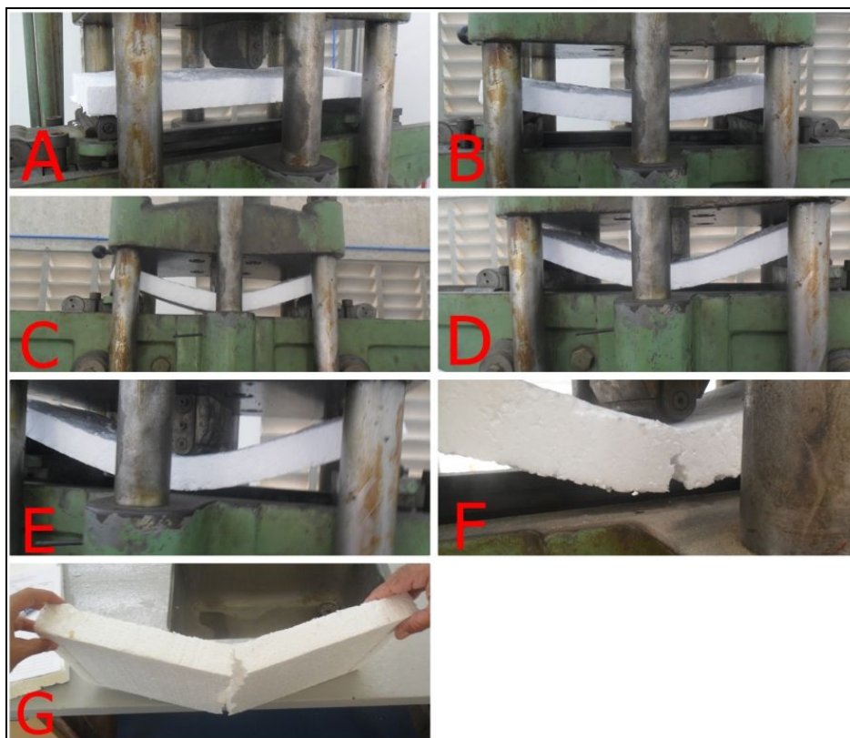
Figura 4: Processo de ensaio de tração na flexão com EPS. Fonte: Autor do trabalho.
