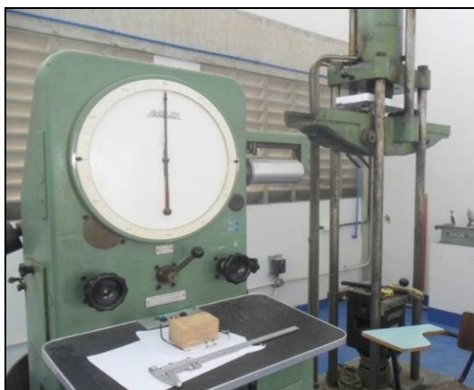
Figura 2: Máquina universal de ensaios (tração, compressão, flexão). Fonte: Autor do Trabalho.
