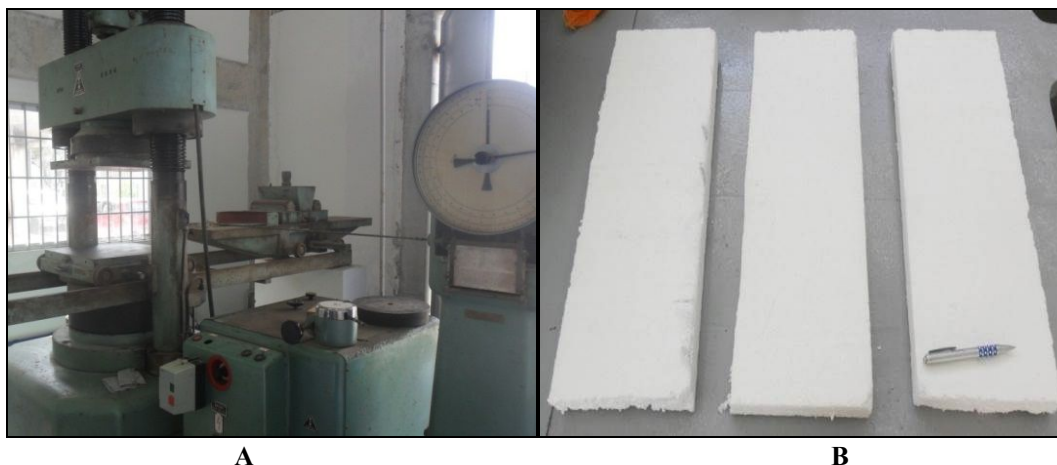
Figura 1: Bases de compressão e o relógio de medição de força da máquina de compressão e protótipos do bloco de EPS. Fonte: Autor do Trabalho.
