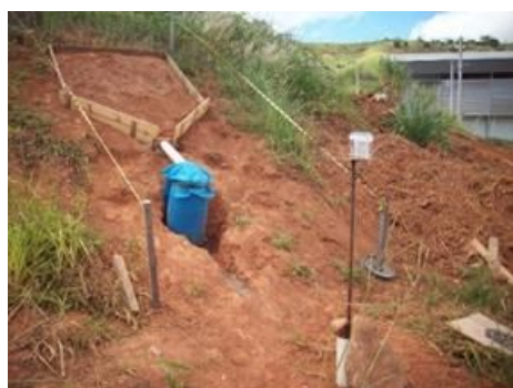
Vista da PC-2 – Pluviômetro auxiliar
