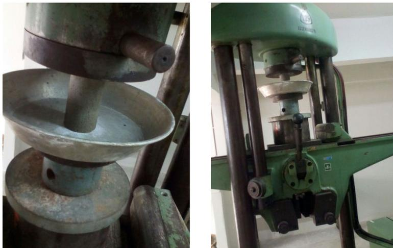
**Figura 4: Determinação da resistência à compressão simples das argamassas em estudo.**
