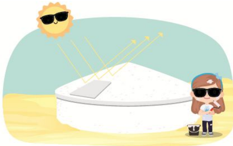
Figura 3: Representação do efeito de pintar a cisterna como forma de proteção contra os raios solares. Fonte: Autor do trabalho.
