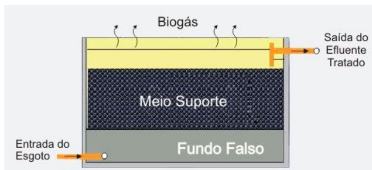
Figura 3: Filtro anaeróbico retangular de fluxo ascendente. Fonte: Natural Tec
