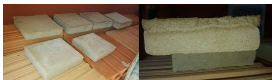
Figura 04 - Placas cimentícias já corrigidas à esquerda e uma delas em perfil após a secagem à direita.
