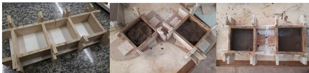
Figura 02 - Fôrmas para moldagem e as placas cimentícias.
