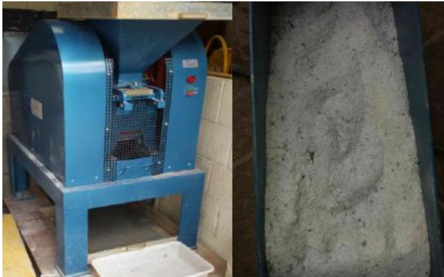
**Figura 4: Britador mecânico**
