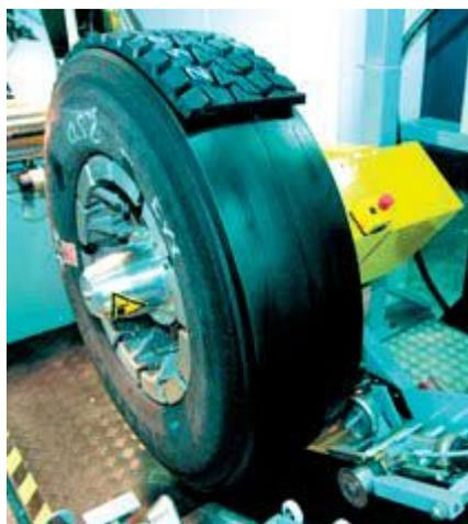
**Figura 2 – Processo de recauchutagem.** Fonte: MATTIOLI, 2009.
