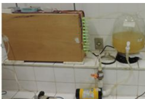
Figura 3: Fotorreator desenvolvido para o estudo de degradação de poluentes em escala de bancada. Fonte: D'Almeida, 2015.
