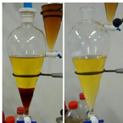
**Figura 8: Resultado da reação de transesterificação. Biodiesel + Glicerina (à esquerda) e Biodiesel (à direita). Fonte: Autor do trabalho.**
