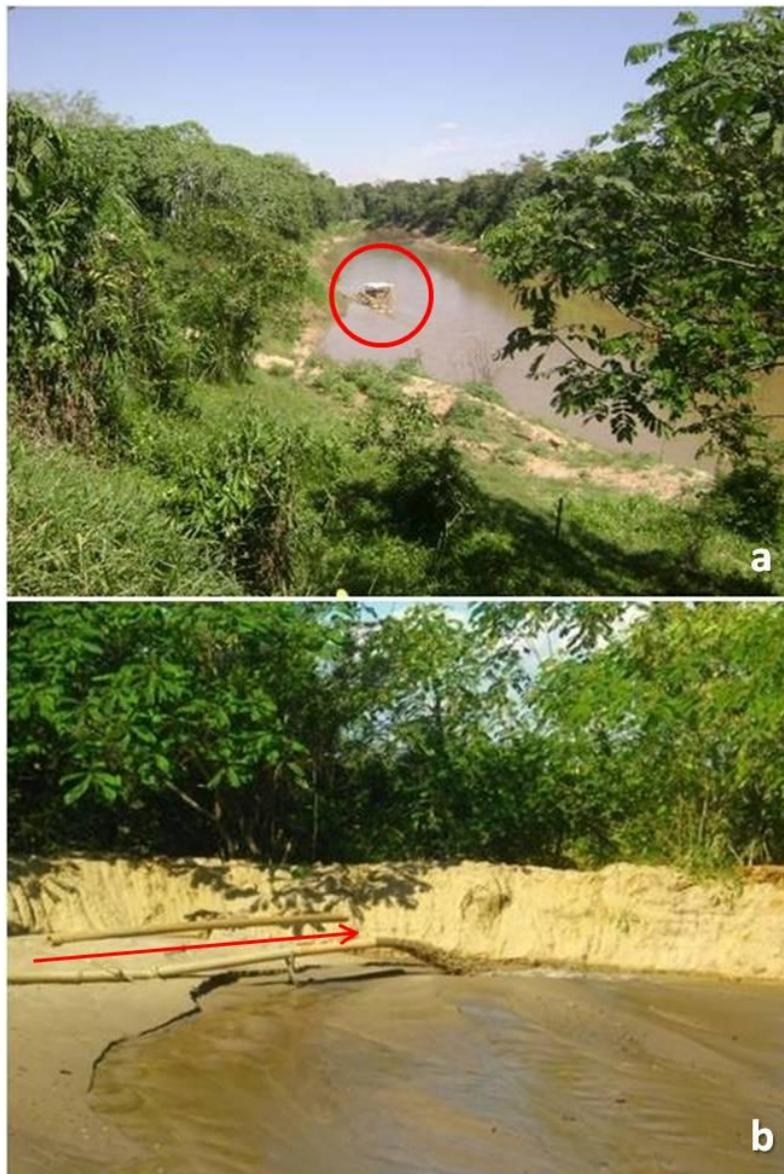
Figura 1: Aspectos da mineração de areia do leito do rio Acre em Rio Branco: a) Drega sugando areia do leito do rio (destacada no círculo vermelho); b) Bombeamento da areia sugada do leito do rio para canchas de armazenamento abertas na Área de Preservação Permanente (APP) (seta vermelha).
