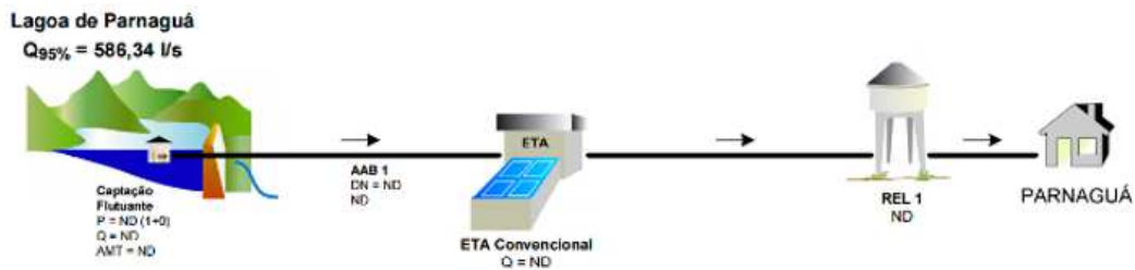
Figura 2: Modelo do sistema do abastecimento de água do município de Parnaguá - PI. Fonte: ANA, 2010.
