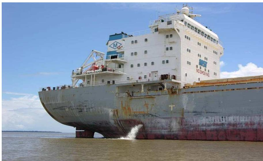
Figura 1: Navio com descarte da água de lastro. Fonte: Porto e Navios (2015).
