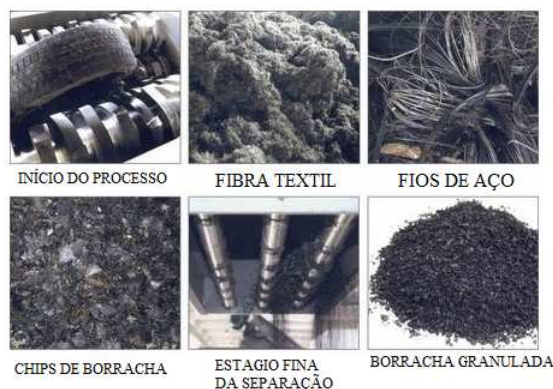
Figura 4 - Processo de separação dos materiais constituintes do pneu de borracha
