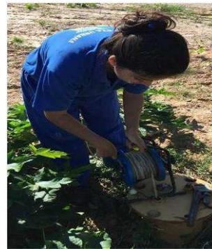
Figura 7 – Monitoramento dos piezômetros
