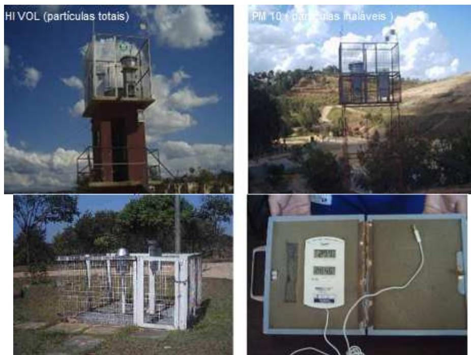
Figura 5 – Equipamentos para o monitoramento da qualidade do ar (Pluviógrafo, Pluviômetro e Termo-higrômetro, HIVOL- partículas totaise PM10- partículas inaláveis)
