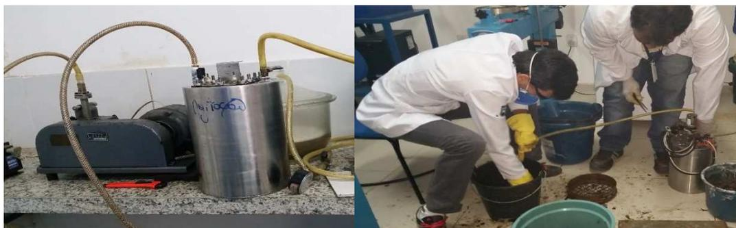
**Figura 3: Enchimento dos biorreatores com auxílio de bomba à vácuo. Fonte: Acervo da pesquisa (2016).**
