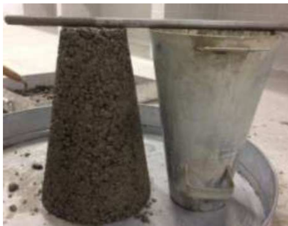
Figura 3: Determinação da consistência do concreto através do abatimento do tronco de cone. Fonte: Autores do trabalho.
