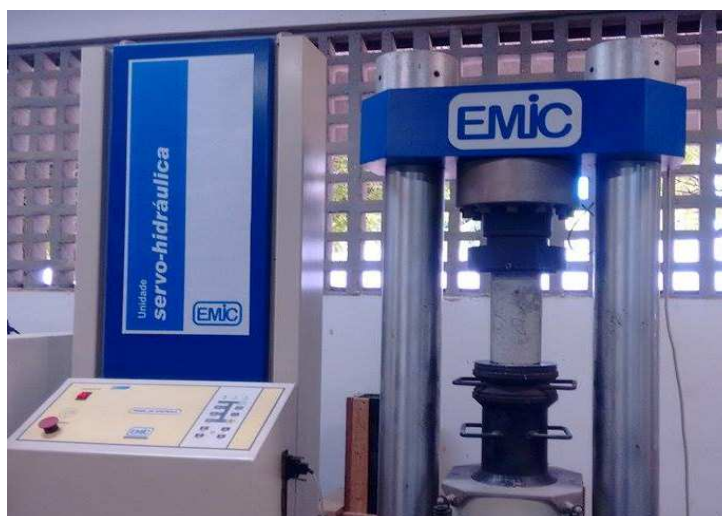
Figura 2: Máquina utilizada nos ensaios de compressão (EMIC SSH 300). Fonte: Autores do trabalho.
