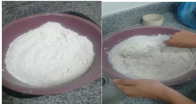
Figura 3 – Preparação da pasta de gesso + pasta celulósica: amostra de gesso (à esquerda) e pasta pronta (à direita). Fonte: Própria, 2016.
