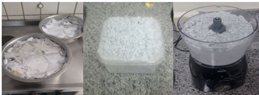
Figura 2 – preparação da pasta de papel: a) amostra de papel cortado (à esquerda); b) papel imerso em água(ao centro); c) trituração do papel (à direita). Fonte: Própria, 2016
