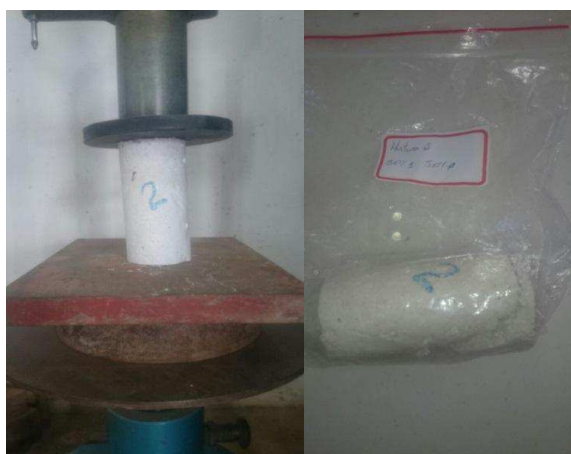
Figura 5 – Ensaio de resistência à compressão simples: corpo de prova na prensa (à esquerda); corpo de prova após o ensaio (à direita). Fonte: Própria, 2016
