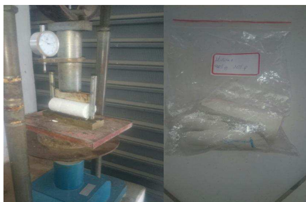
Figura 6 – Ensaio de resistência à tração, por compressão diametral: corpo de prova na prensa (à esquerda); corpo de prova após o ensaio (à direita). Fonte: Própria, 2016
