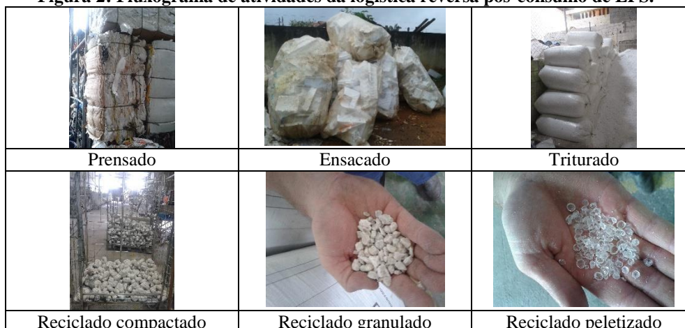
Figura 3: Fotos dos produtos processados de EPS pós-consumo.
