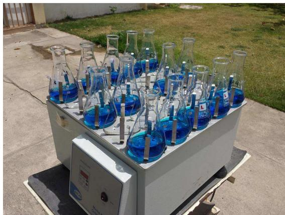
**Figura 1: Experimento de Fotocatalise solar heterogênea do azul de metileno ( $20 \text{ mg/L}$ ). Fonte: Autor do Trabalho.**
