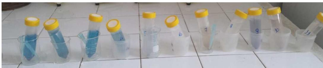
Figura 3: Efluente sintético com azul de metileno fototratado por UV/ $\text{TiO}_2$  (amostras de 1 a 11, da esquerda para direita). Fonte: Autor do Trabalho
