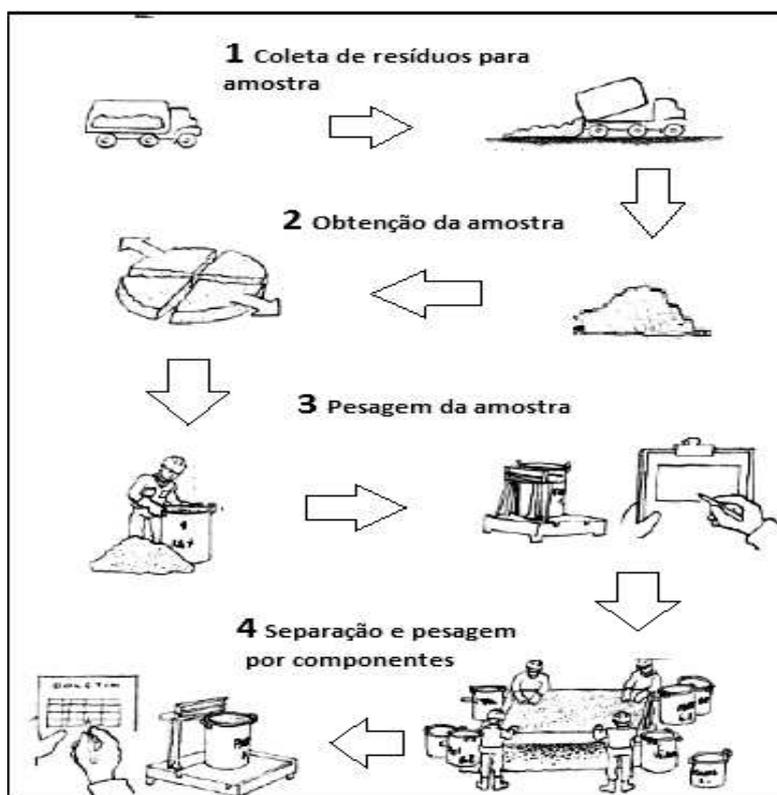
Figura 2: Procedimento de recolha e análise de amostra para realização da técnica de quarteamento. Fonte: Adaptado de Martinho e Gonçalves (2000, p. 48) apud GASQUES, 2013.
