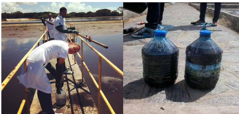
Figura 2: Materiais e procedimento de coleta do lodo anaeróbio. Fonte: Autor do Trabalho.
