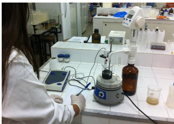
Figura 3: Realização da análise físico-química do lodo anaeróbio. Fonte: Autor do Trabalho.
