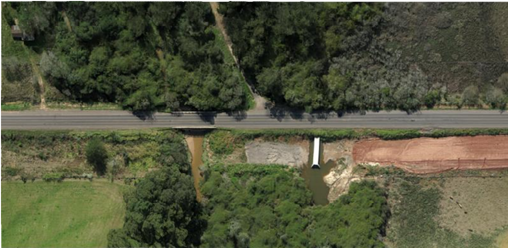
Figura 5: Imagem ortorretificada montada a partir de diversas fotos. A partir dela é possível medir distâncias e áreas com alta precisão.
