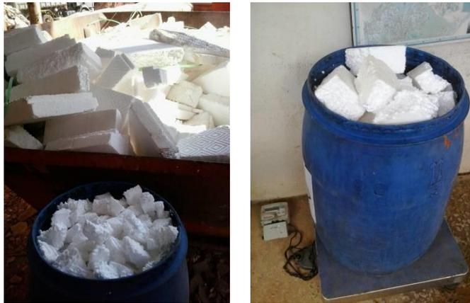
Figura 1- Separação e pesagem da amostra do RCC avaliado
