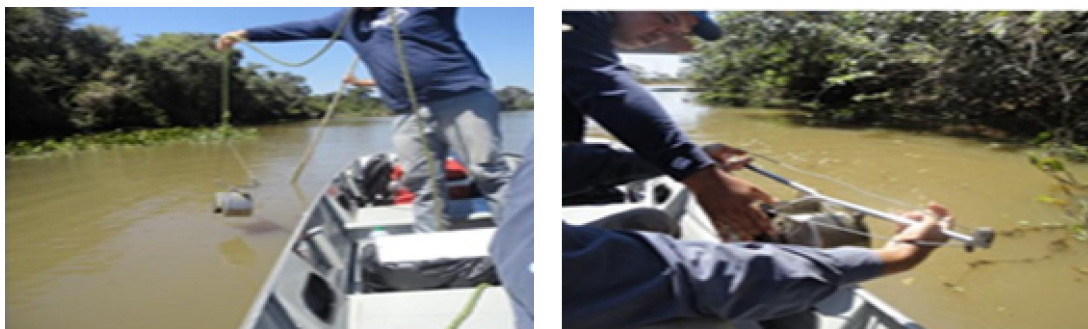
Figura 2: Coleta de sedimentos com amostrador Van-Veen. Fonte: CORINGA,2014.
