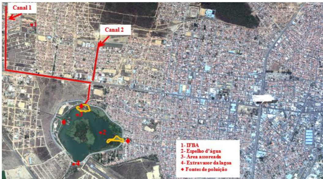
Figura 1. Foto aérea mostrando o canal de rede pluvial (linha vermelha), o IFBA, a Lagoa das Bateias e a área assoreada da Lagoa (vide legenda)
