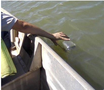
Figura 1: amostragem de água superficial para análise laboratorial de parâmetros tais como pH. Fonte: Autor (2014).
