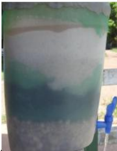
Figura 1: Camadas do Biofiltro. Fonte: Autores do trabalho
