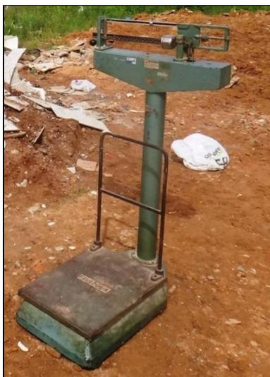
**Figura 3 - Balança mecânica com capacidade para 300 kg.**
