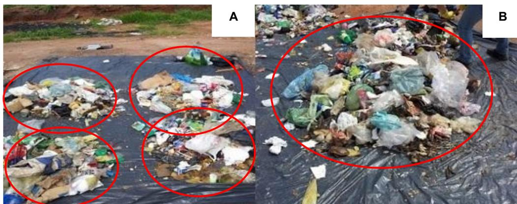
Figura 3: A) Divisão do volume em quatro partes. B) Mistura do volume anteriormente separado para posterior divisão em dois, mistura novamente, segregação dos grupos previamente escolhidos na diagonal e por fim a pesagem desses. Fonte: Autores (2014).
