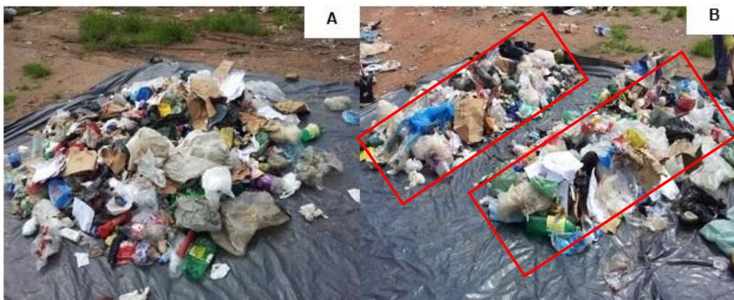
Figura 2: A) Início do quartejamento, com o despejo do material em lona. B) Divisão do volume total em duas partes. Fonte: Autores (2014).
