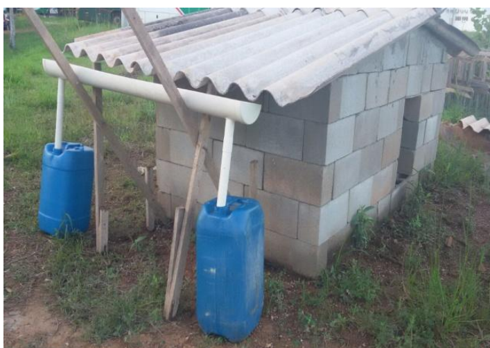
Figura 2: Modelo Experimental com calha e galões para coleta (Fonte: CAVALCANTE, G. 2015).
