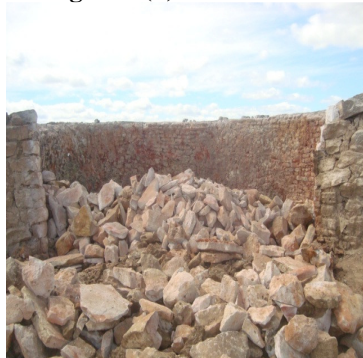
FIGURA 1- Principais insumos para a produção da cal: matéria-prima pedra calcária (a) e lenha como fonte energética (b) em Governador Dix-Sept Rosado, 2014. Fonte: Autoras do Trabalho.
