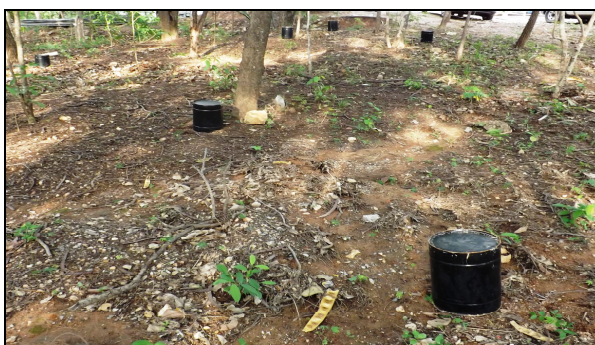
Figura 2. Campânulas (baldes plásticos) na área de coleta de efluxo de CO 2 do solo. Fonte: Autoras do Trabalho
