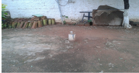
Figura 1. Poço de monitoramento do Cemitério São Gonçalo, Cuiabá-MT. Fonte: Autor do trabalho.
