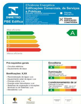
Figura 01 – ENCE Geral de Edifício Construído (ELETROBRAS/PROCEL, 2013).
