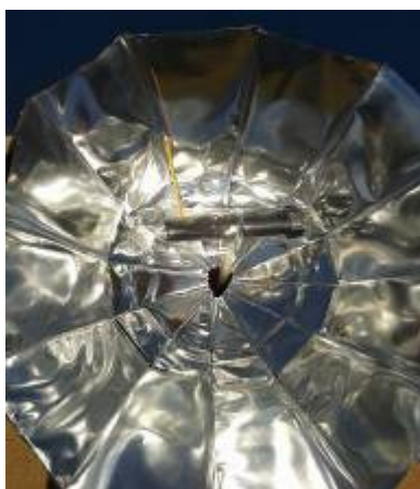
Figura 18: Concentrador Solar como Extrator
