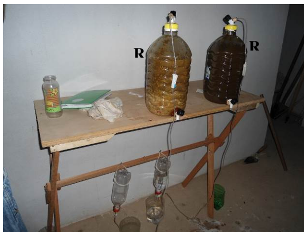
Figura 1: Reatores desenhados para a digestão anaeróbia de resíduos sólidos. R1 esterco bovino, R2 resíduos de alimentos/ esterco bovino. Na parte inferior se observam os gasômetros de água. Fonte: M. Azevedo.
