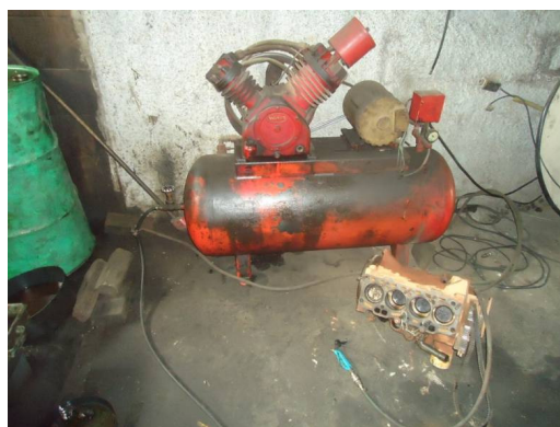
Figura 03: Compressor utilizado para secagem de peças na oficina mecânica em Contagem (MG). Fonte: Acervo dos autores, 2014.
