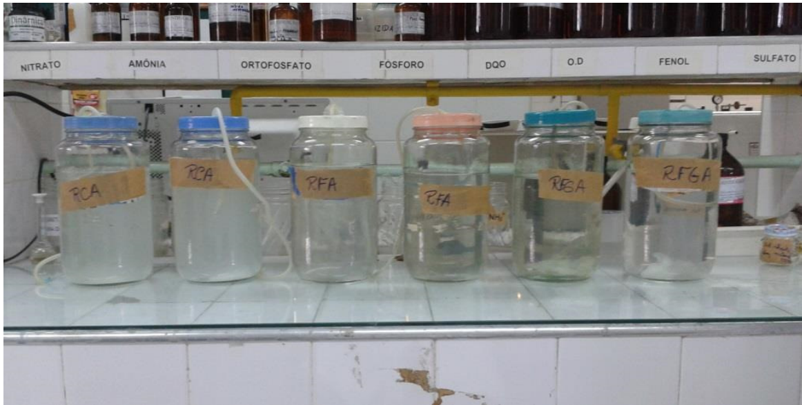
Figura 2: Reatores em batelada aerada com biomassa dispersa de Aspergillus niger AN 400
