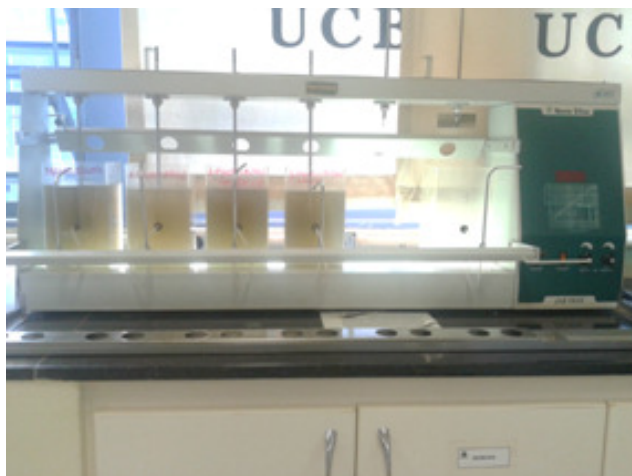
Figura 9: Jar-test. Fonte: Autores do trabalho.
