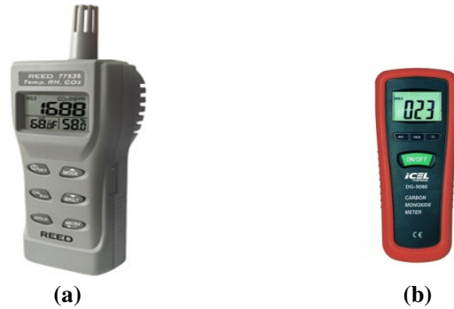
Figura 2 – (a) INSTRUTEMP (Instrutor de Medições LTDA), modelo AZ 77535. (b) Medidor de monóxido de carbono (CO), marca ICEL, modelo DG-5080
