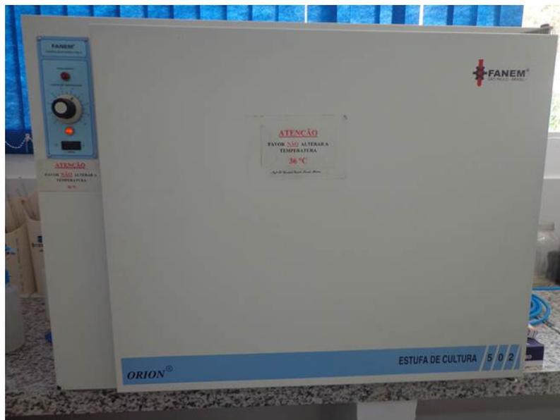
Figura 4: Estufa usada para acondicionar as placas de Petri com as amostras de resíduos orgânicos inoculadas em meios aeróbios.
