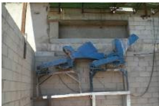
Figura 5: indica o equipamento utilizado para a moagem do resíduo Classe A. Fonte: Case CRV Construtora
