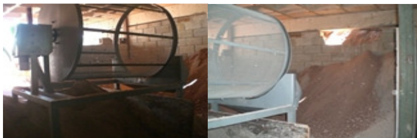
Figura 6: equipamento utilizado para peneirar o subproduto dos resíduos Classe A, quais sejam: areia fina e média. Fonte: Case CRV Construtora
