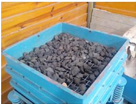
Figura 2 – Peneiramento do material fresado.
