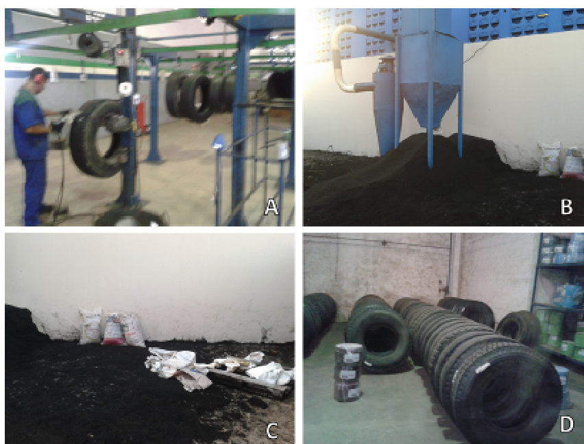
Figura 1: A - processo de renovação de pneus; B - Área de armazenamento temporário do resíduo oriundo do processo de renovação; C - Área de armazenamento temporário do resíduo oriundo do processo de renovação; D - Pneus estocados depois do processo de renovação.
